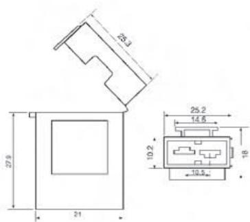
**Описание:** влагостойкий держатель флажкового предохранителя.
